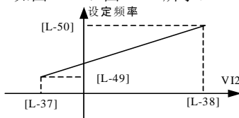
图 5-19 单极性控制 ( [L-41] = 0 ) 时 VI2 与设定频率的对应关系
