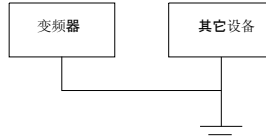
图 2-16 变频器与其它设备接地示意图 3
