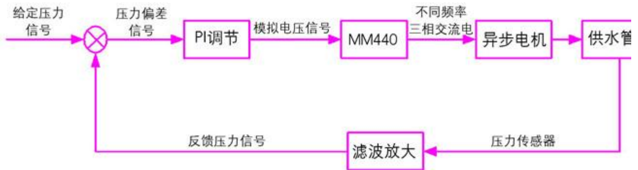
图 3 变频恒压供水系统的控制原理框图
